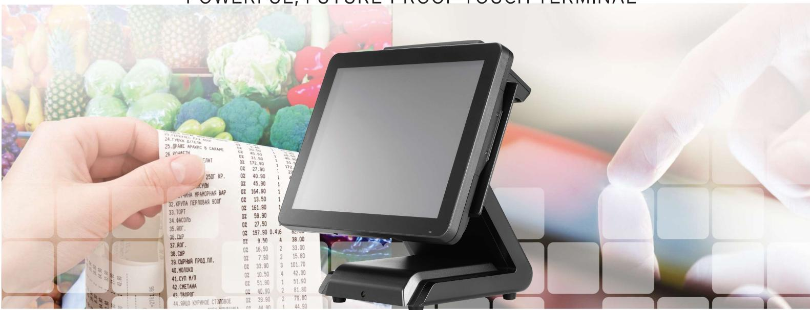
随着技术的进步和消费趋势的变化，会有越来越多新的运用出现。SP-1060是一款顶级POS商用机，设计出发点是应全球商业市场强大的硬件功能和使用寿命要求，产品设计CPU可选择Intel Celeron G3900TE可升级至i3、i5、i7，支持英特尔主动管理技术（iAMT），允许设备诊断和远程修复，最终降低支持成本。丰富的接口设计，同时配有HDMI和VGA可实现三屏显示功能。依其卓越的性能，将在IOT解决方案和未来新零售中扮演重要的角色。
